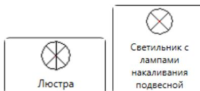
Рис. 128. Используемые типы светильников
