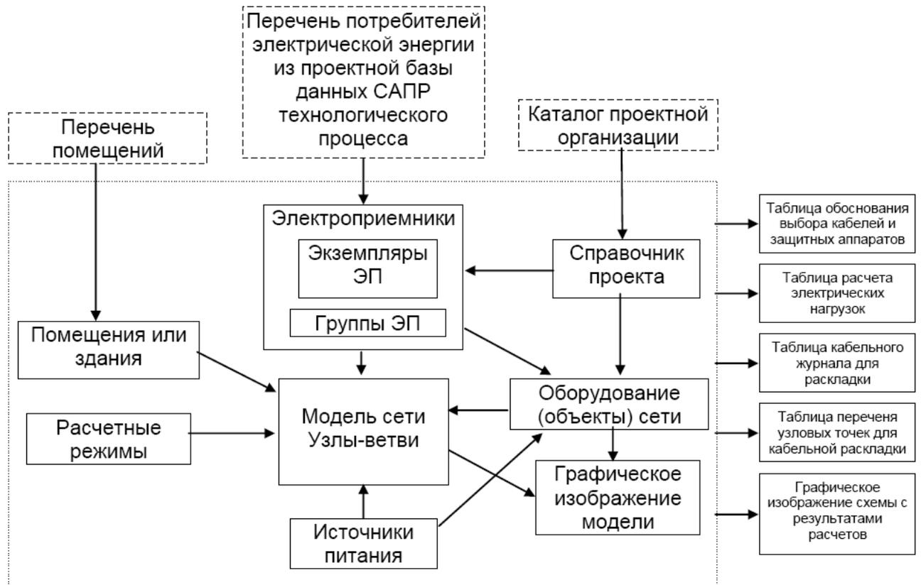
Рис. 35. Логическая схема базы данных модели. Пунктиром показаны внешние по отношению к программному комплексу компоненты EnergyCS Электрика v 3, которые не являются обязательными.
